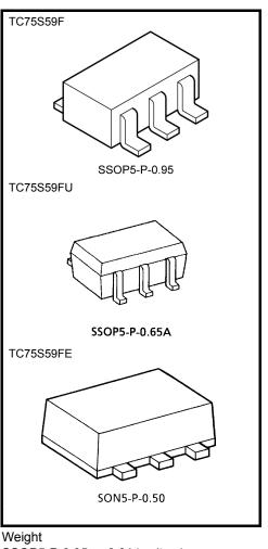
SSOP5-P-0.95 : 0.014 g (typ.) SSOP5-P-0.65A : 0.006 g (typ.) SON5-P-0.50 : 0.003 g (typ.)
