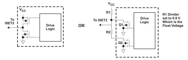
图 13. 3-state ISET2 Terminal Circuits
